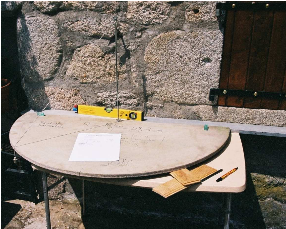
Figure 4 La planchette: vue générale lors d'un relevé de mur
