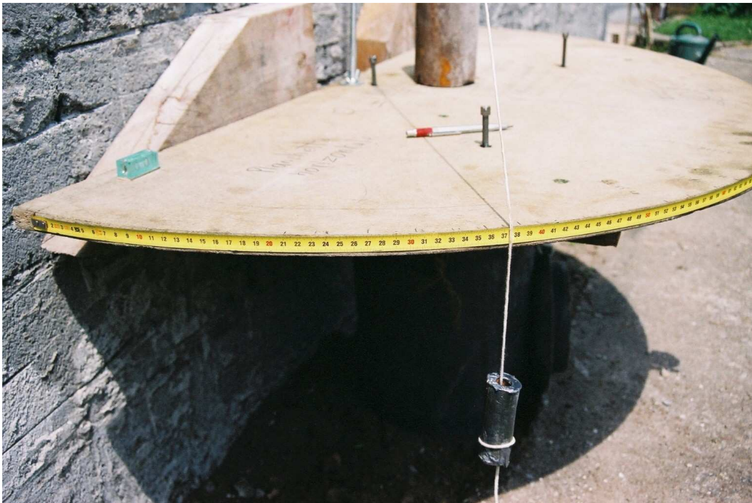
Figure 3 La planchette : mesure de l'angle « ombre/mur » au dixième de degrés près.
